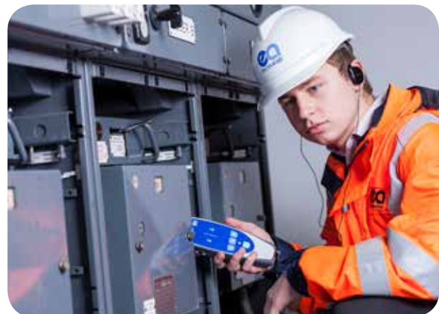
UltraTEV Detector 2 - ultrasonic mode
